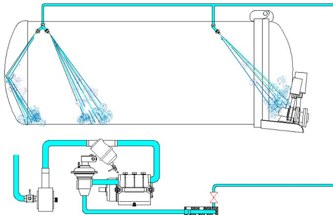
**FLUSSAGGIO ADR** in cisterna per la pulizia interna con getti d'acqua ad alta pressione montati sulla sommità della cisterna. Tali getti vengono comandati tramite valvola di intercettazione pneumatica alimentata direttamente dal collettore alta pressione.
