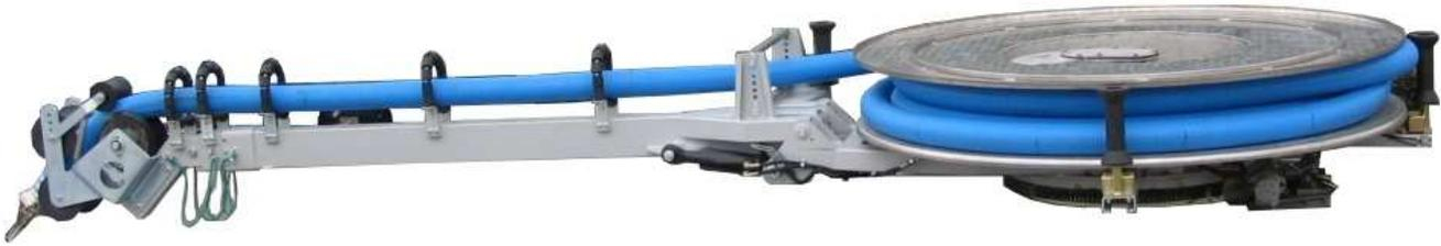
**ASPO DI ASPIRAZIONE** completamente servoassistito, con tubo flessibile per aspirazione collegato allo scomparto fanghi con giunti girevoli, trascinamento e guidatubo automatici, saracinesca di chiusura a comando pneumatico sulla cisterna, **con braccio direzionale guidatubo** a rotazione idraulica coassiale, allungamento a sfilo idraulico, movimenti alza ed abbassa idraulici.
